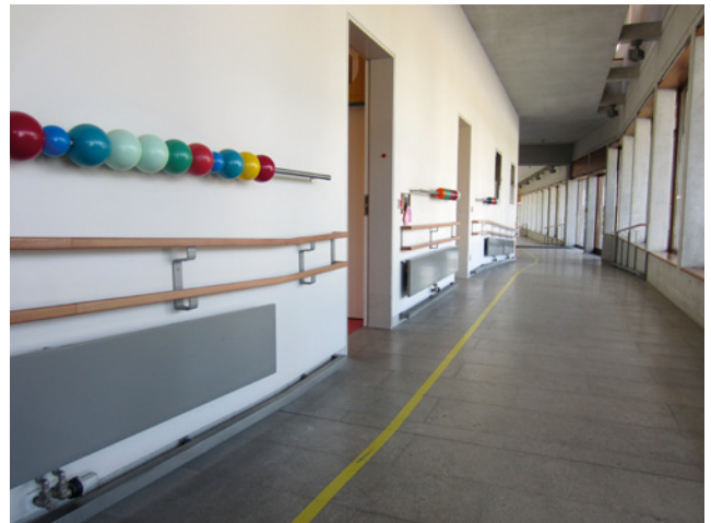
Das schmale, gelbe Klebeband wirkt als Leitlinie, obwohl der Kontrast zum Natursteinbelag gering ist
