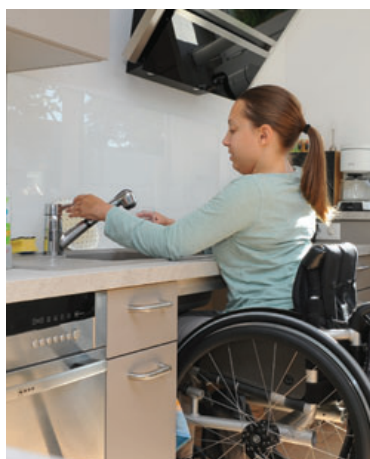
121 – 122 In einer mit dem Rollstuhl nutzbaren Küche ermöglicht eine unterfahrbare Spüle die frontale Nutzung. Ein Backofen mit versenkbarer Tür und Ablage bietet Schutz vor Verbrennungen; Privathaus, Mainz
