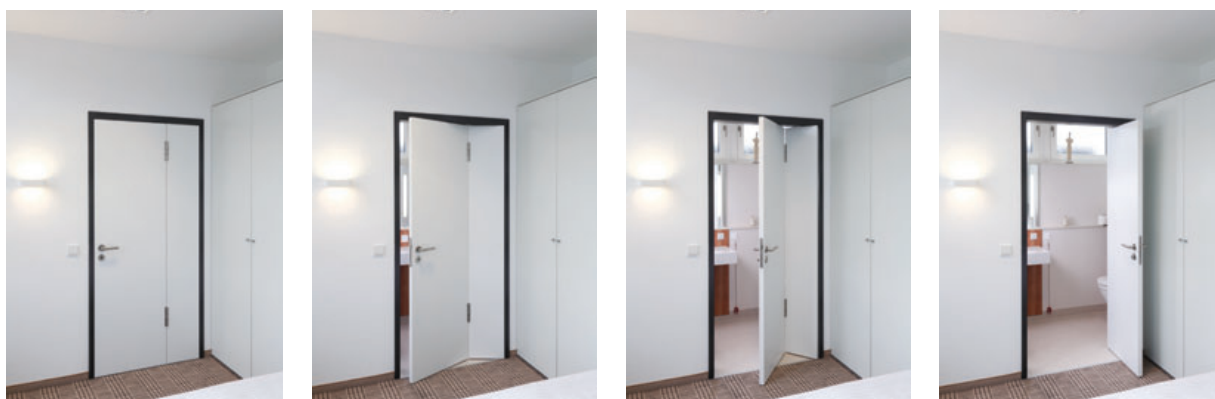
86 – 89 Mit Raumpartüren können Bewegungsflächen für Rollstuhlfahrerinnen und -fahrer sowie Nutzerinnen und Nutzer von Rollatoren minimiert werden. Eine frontale Durchfahrt ist von beiden Seiten möglich.
