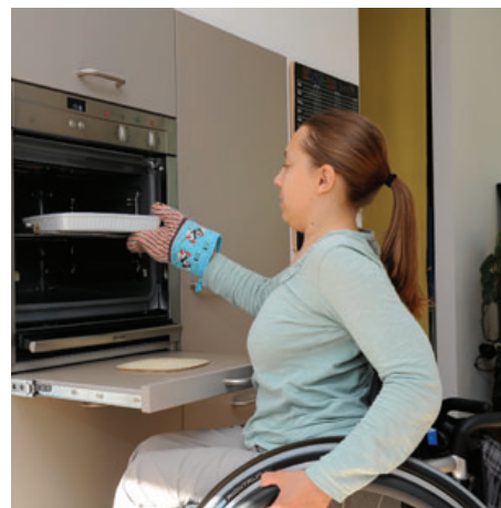
121 – 122 In einer mit dem Rollstuhl nutzbaren Küche ermöglicht eine unterfahrbare Spüle die frontale Nutzung. Ein Backofen mit versenkbarer Tür und Ablage bietet Schutz vor Verbrennungen; Privathaus, Mainz
