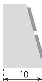
72 Geneigtes Bedientableau nach DIN EN 81-70 (Anhang G) mit Befehlsgebern Typ XL
